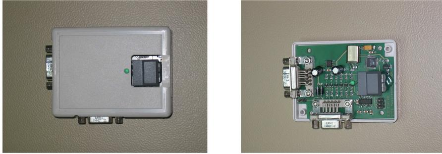
Abbildung 4: Die externe Zeitmessbox. Im Inneren übernimmt ein Mikrorechner die Zeitmessung.
